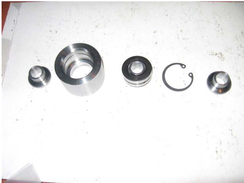
Exemple de montage de cage à rotule spéciale
