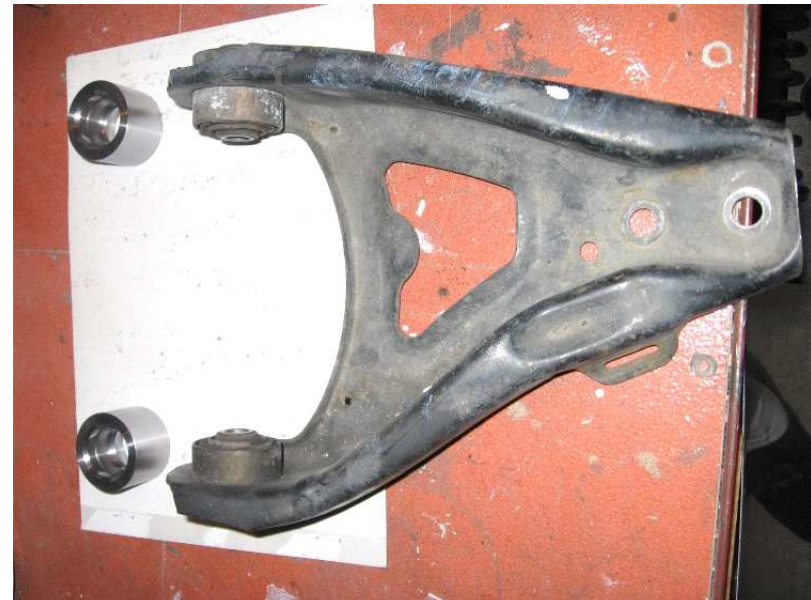
Les cages sont ensuite soudées sur le triangle à la place des articulations élastiques (emmanchées)
